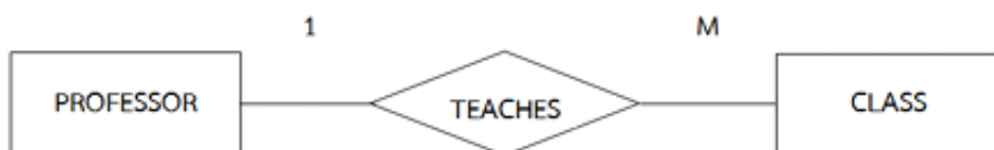
ภาพที่ 2.4 แสดงความสัมพันธ์แบบ One to Many Relationships
