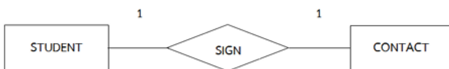
ภาพที่ 2.3 แสดงความสัมพันธ์แบบ One to One Relationships
